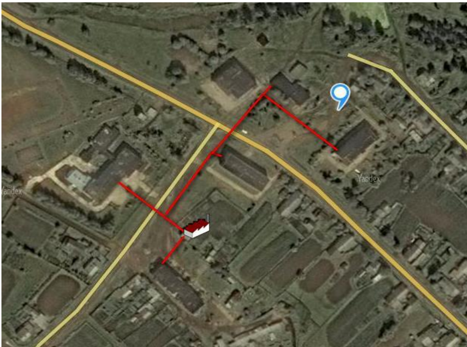
Рис 38 Схема тепловой сети в зоне действия котельной № 2 подлежащая реконструкции
